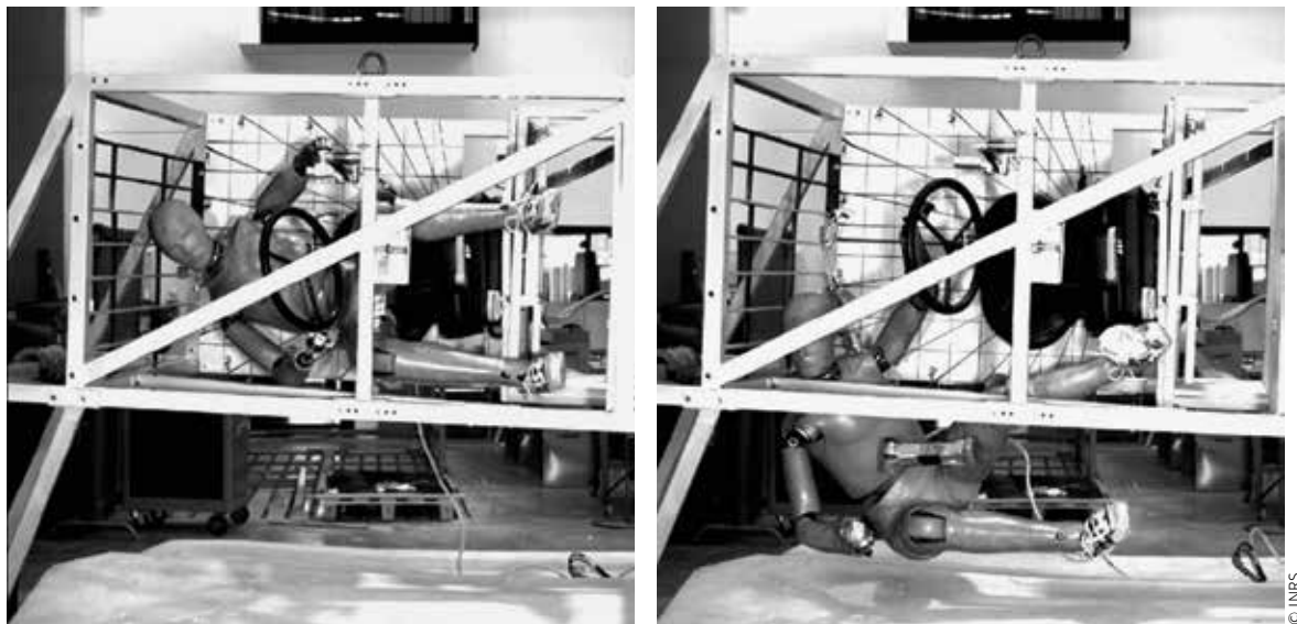
FIGURE 5 → Vue de face du mouvement du mannequin dans la configuration de référence, sans système de protection.
