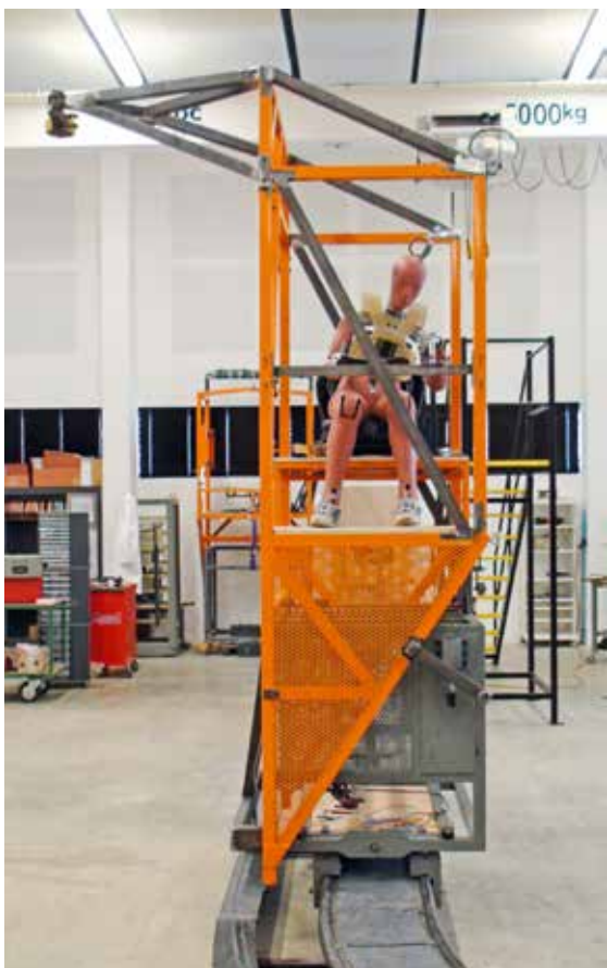
↑ FIGURE 3 Cabine simplifiée de chariot élévateur montée sur son berceau.
